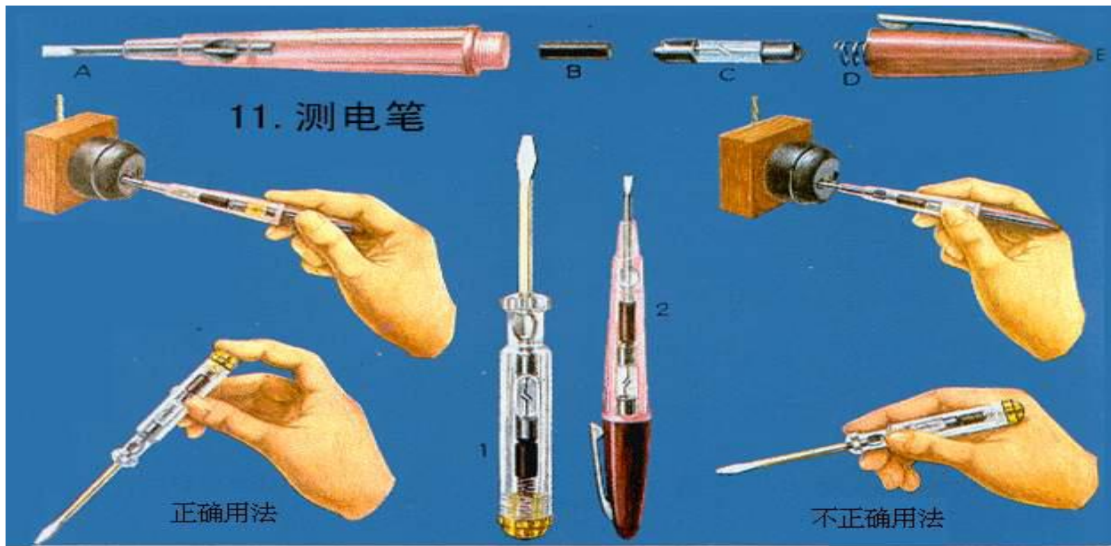
1. 螺旋刀式 2. 钢笔式 A. 笔尖金属体 B. 电阻 C. 氖管 D. 弹簧 E. 笔尾金属体
